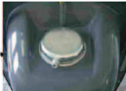
Fig.3 Per togliere la flangia di ispezione bisogna svitare i dadi di fissaggio, prima di svitarli bisogna ingrassarli.
